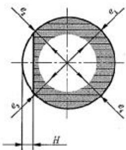
图 B.2 淬透深度的测定示意图
